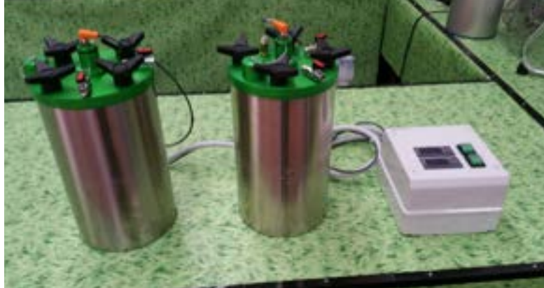
Figura 11 Strumento Methantube a due serbatoi con quadro di controllo
