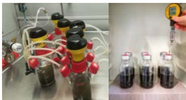
Figura 6 Bottiglia di OxiTop® (a sinistra) e bottiglie standard (a destra) utilizzate nelle prove in batch
