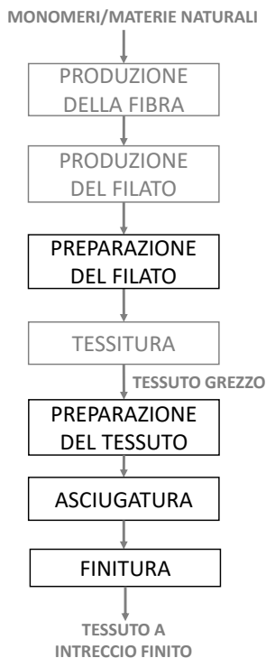
Figura 61. Schema di processo “tipo” di produzione di tessuti a intreccio definito nell’ambito del presente progetto
