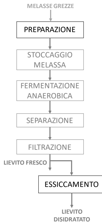
Figura 51. Schema di processo "tipo" di produzione del lievito di birra definito nell'ambito del presente progetto
