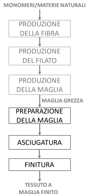
Figura 62. Schema di processo “tipo” di produzione di tessuti a maglia definito nell’ambito del presente progetto
