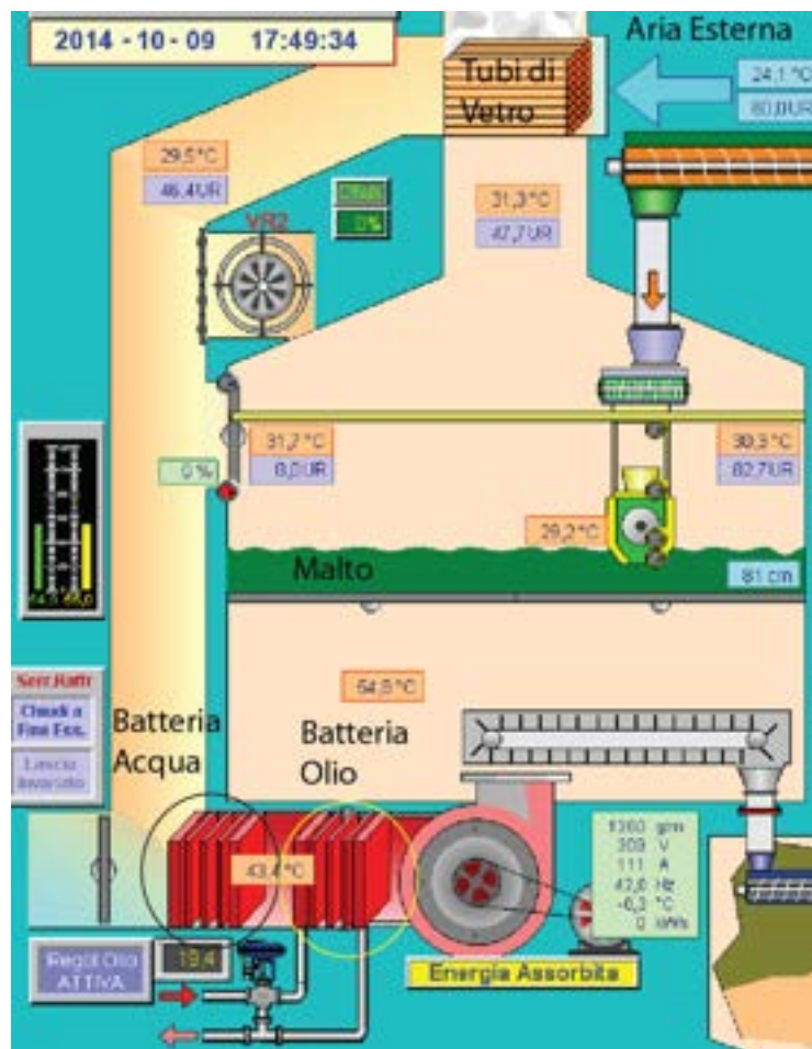
Figura 68: Schema funzionamento impianto di essiccazione orzo per la produzione di malto
