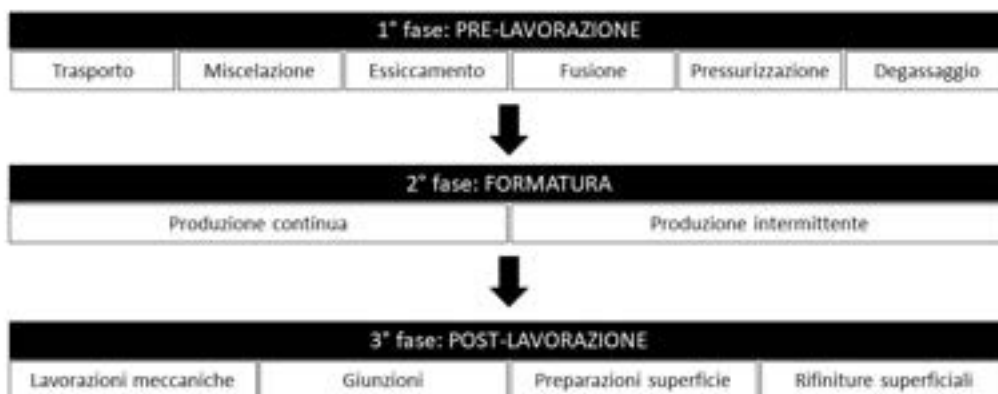
Figura 7: ciclo di lavorazione della plastica.
