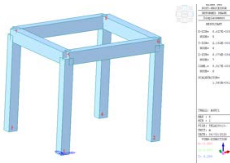
Figura 117. Massimo spostamento per accelerogramma non scalato e numerazione nodi
