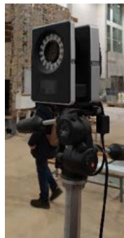
Figura 282. Vista di una telecamera del sistema 3DVision
