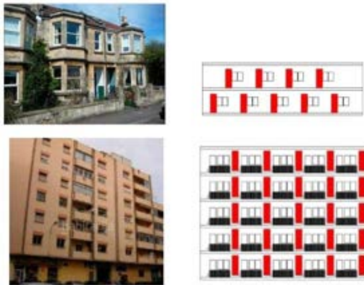
Figura 41. Progetto E2VENT – Distribuzione unità LHTES e SMHRU per due morfologie di facciata
