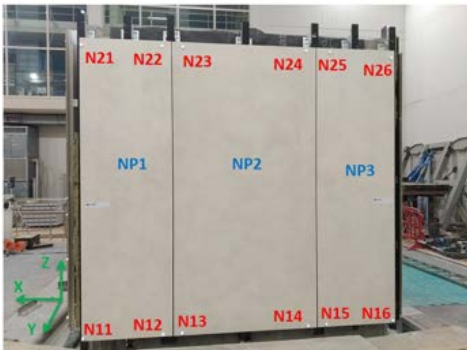
Figura 284. Posizione dei punti di misura sul lato nord: la nomenclatura indica in rosso i markers , in viola gli accelerometri, in blu i pannelli
