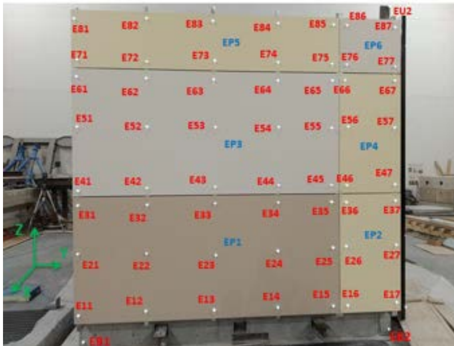
Figura 286. Posizione dei punti di misura sul lato est: la nomenclatura indica in rosso i markers , in viola gli accelerometri, in blu i pannelli
