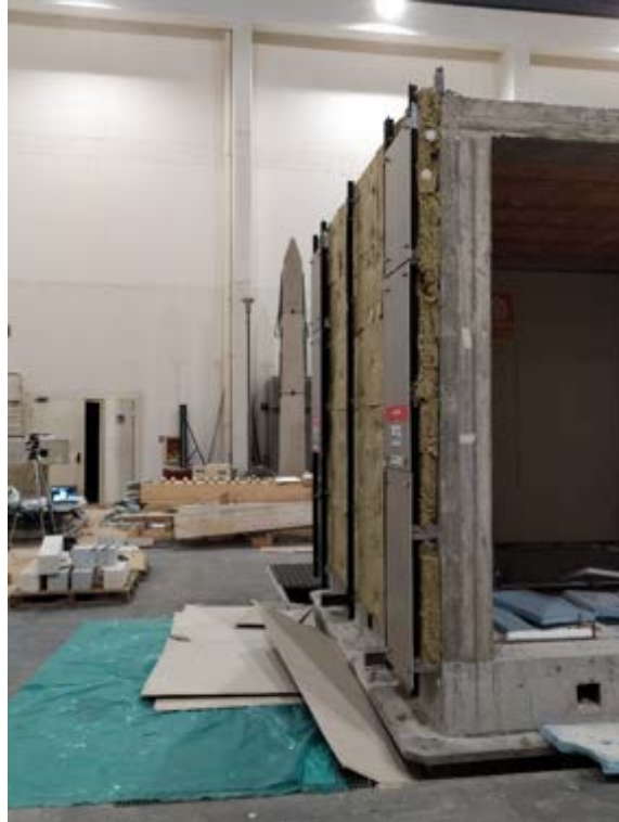
Figura 293. Parete ovest al termine del test "sint_1.40g"
