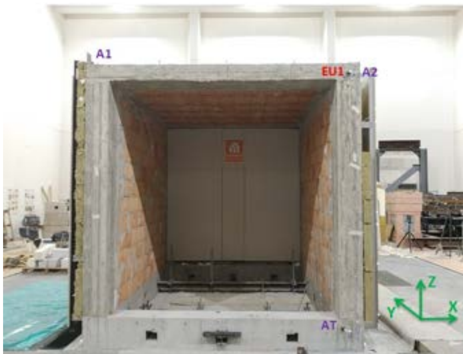
Figura 287. Posizione dei punti di misura sul lato sud: la nomenclatura indica in rosso i markers , in viola gli accelerometri, in blu i pannelli
