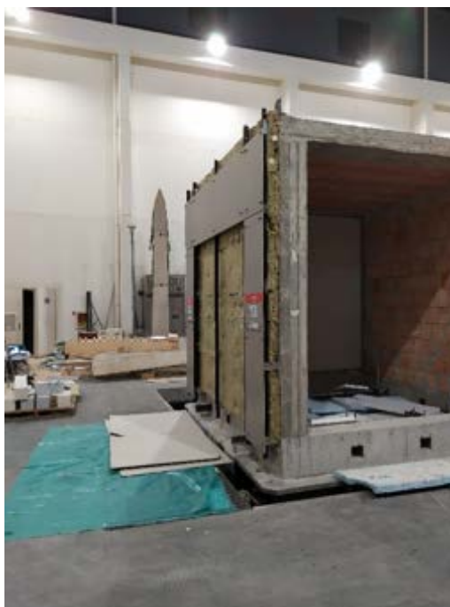
Figura 292. Parete ovest, test “sint_1.00g”: caduta dei pannelli WP2 e WP5.
