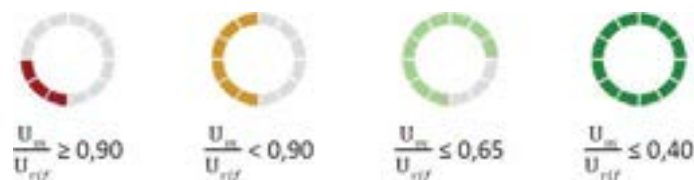
Figura 45. Criterio di assegnazione del livello di prestazione per trasmittanza media di parete e copertura
