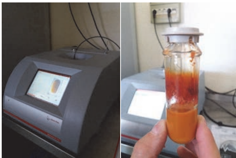
Figura 27. Reattore a microonde e prodotto post-sintesi.
