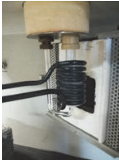
Figura 40. Induttore posizionato intorno al reattore in vetro contenente il letto di materiale attivo ed il sensore di temperatura.
