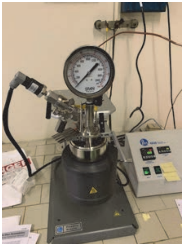
Figura 26. Reattore utilizzato per la sintesi idrotermale
