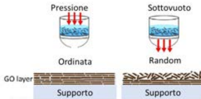
Figura 4 - 7 Schema del metodo di filtrazione sotto vuoto e sotto pressione nella preparazione di membrane di GO.
