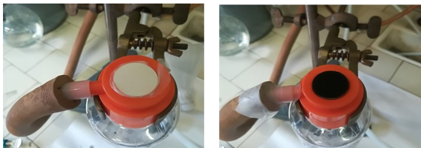
Figura 4 - 11 Set-up di filtrazione sotto vuoto per la produzione di membrane.
