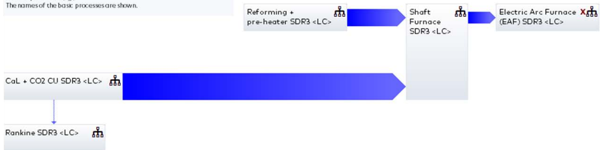
Figura 12 - Schema del sistema SDR3 e corrispondente rappresentazione in GaBi. In rosso sono indicate le emissioni in atmosfera, senza trattamento di decarbonizzazione, in arancione quelle in uscita dal CaL.
