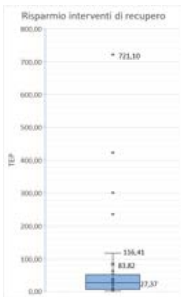
Figura 116: Caratterizzazione della funzione di distribuzione dei risparmi di energia primaria per gli interventi di recupero di calore individuati nel settore prodotti da forno
