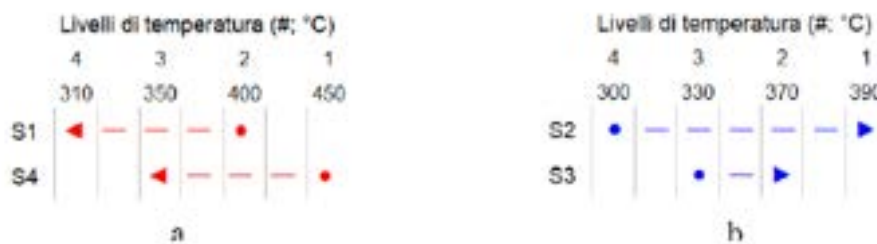
Figura 12 Intervalli di temperatura delle curve cumulative dei fluidi caldi (a) e freddi (b).
