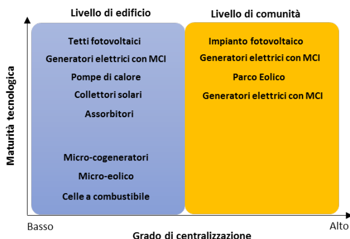
Figura 6: Rappresentazione grafica delle tecnologie per la produzione locale di energia in funzione del grado di centralizzazione e della maturità tecnologica. Elaborata da ENEA da dati provenienti da [26], [27]
