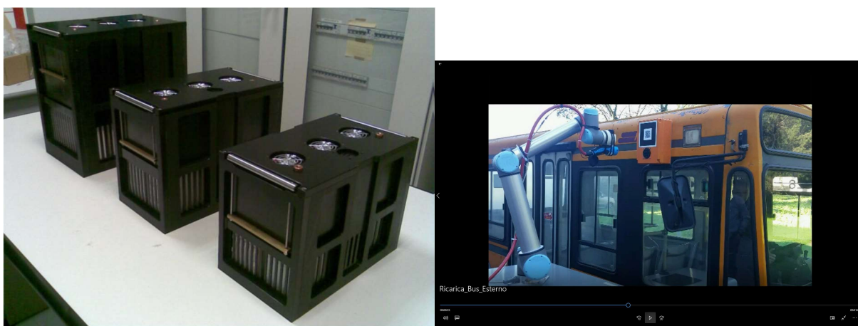
Figura 1 moduli di batteria LFP con ricarica a 3C e ricarica automatizzata tramite braccio robotizzato.
