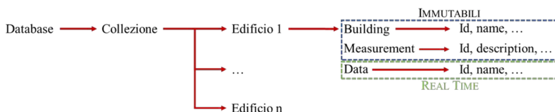
Figura 3 - Schema struttura di memorizzazione
