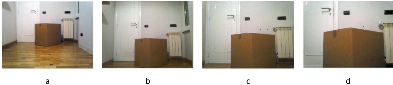
Figura 43 – Test #3: immagini acquisite dalla telecamera del robot prese a diversa distanza dall’ostacolo: a) 200cm, b) 150cm, c) 100 cm, d) 60 cm
