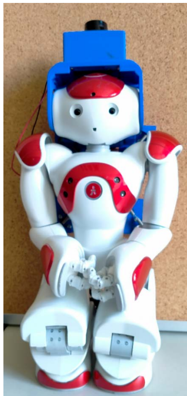
Figura 28 – Robot NAO con sensore laser LRF URG-04LX-UG01 installato sul casco di supporto
