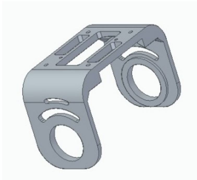
Figura 18 – Disegno in 3D del supporto della testa laser
