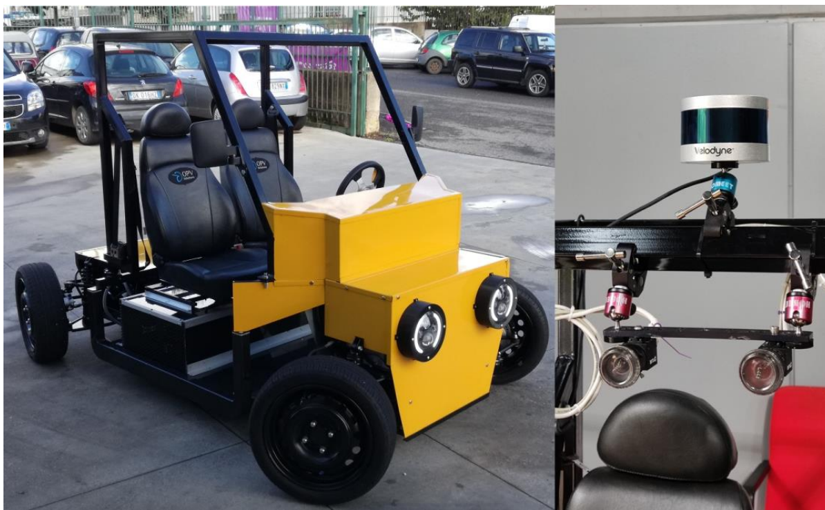
Figura 8. Il veicolo Be-Positive. Sulla destra le telecamere ed il LIDAR montati sull roll-bar frontale
