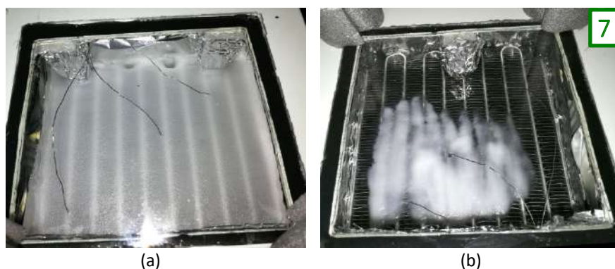
Figura 107 – PCM prima e durante la fusione nella SDP-2: T da 36°C a 56°C con G=15 kg/h - a) t=0; b) t=1671s (punto 7)
