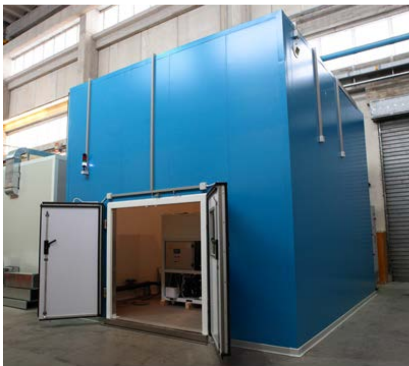
Figura 1 - Camera climatica del CR ENEA Casaccia
