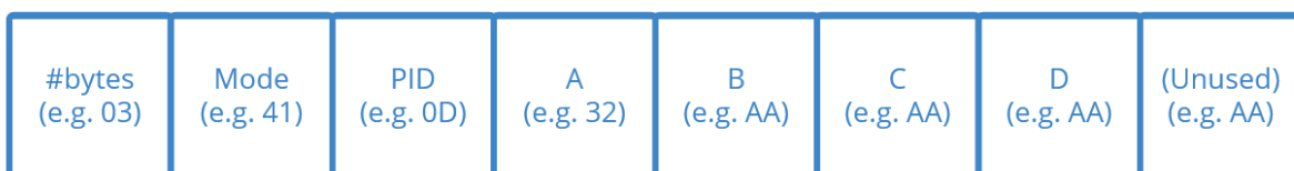
Figura 1 - Struttura del frame OBDII
