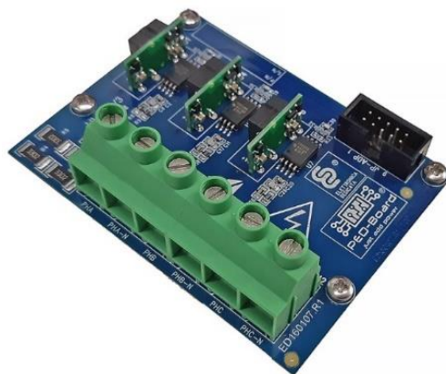
Figura 14. High Voltage Sensing Board per la lettura delle tensioni di rete.
