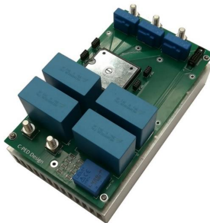
Figura 10 Inverter SiC utilizzato per il collegamento alla rete elettrica
