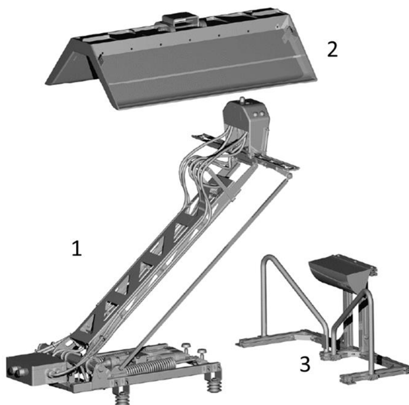
Figura 2 Sistema a pantografo per collegamento elettrico durante ricarica rapida al capolinea
