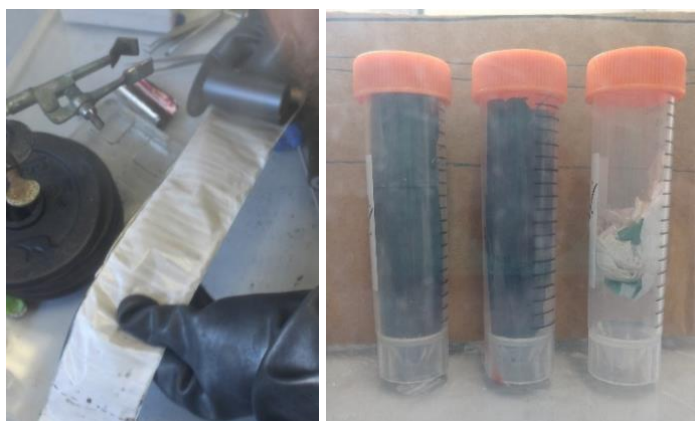
Figura 28: srotolamento della membrana (a) e tubi da 50 ml con anodo, catodo e membrana (b)
