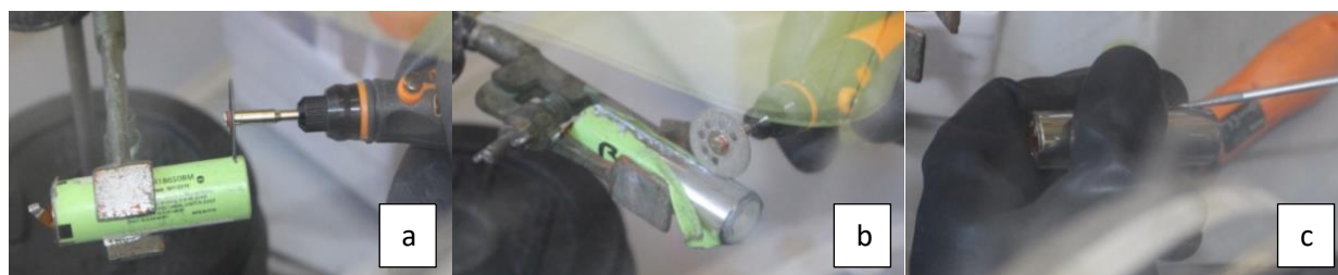
Figura 27: rimozione tappi (a), rimozione alloggiamento plastico (b), rimozione dell'alloggiamento metallico
