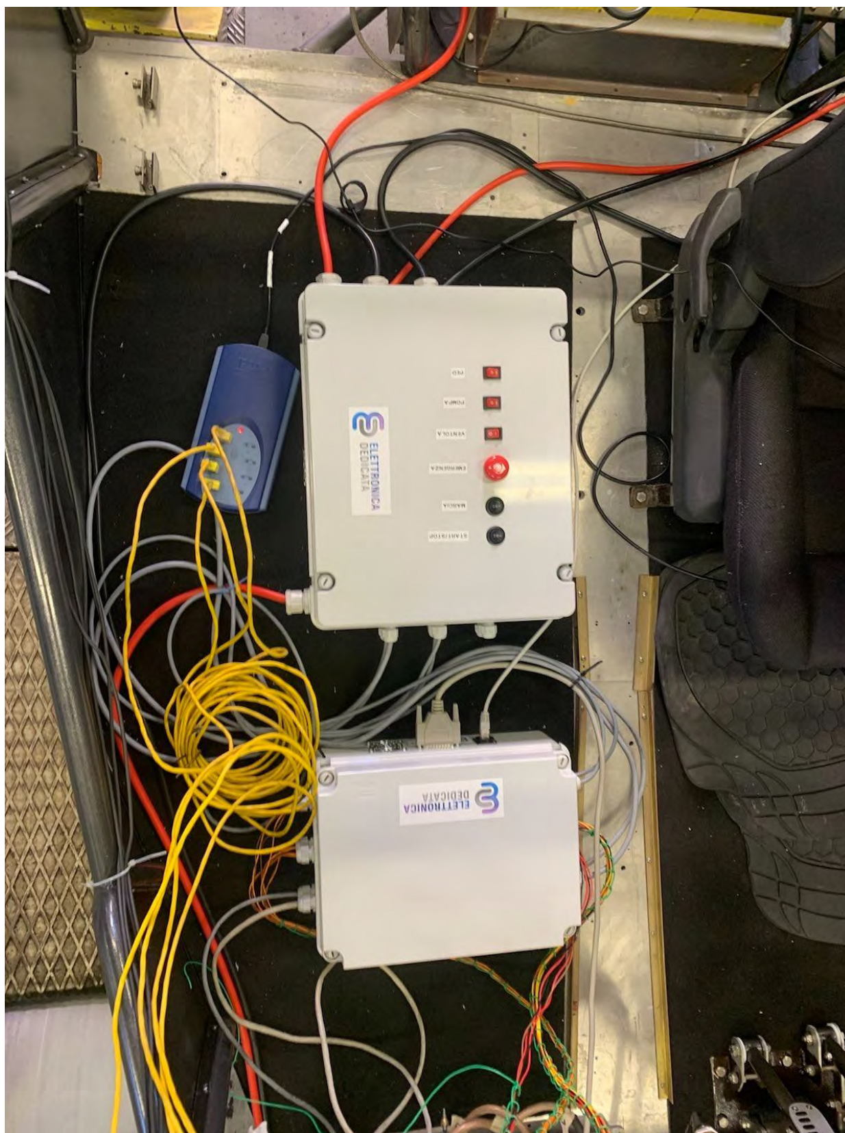
Figura 16 – Sistema di controllo e di acquisizione dati installati a bordo del veicolo elettrico URBE
