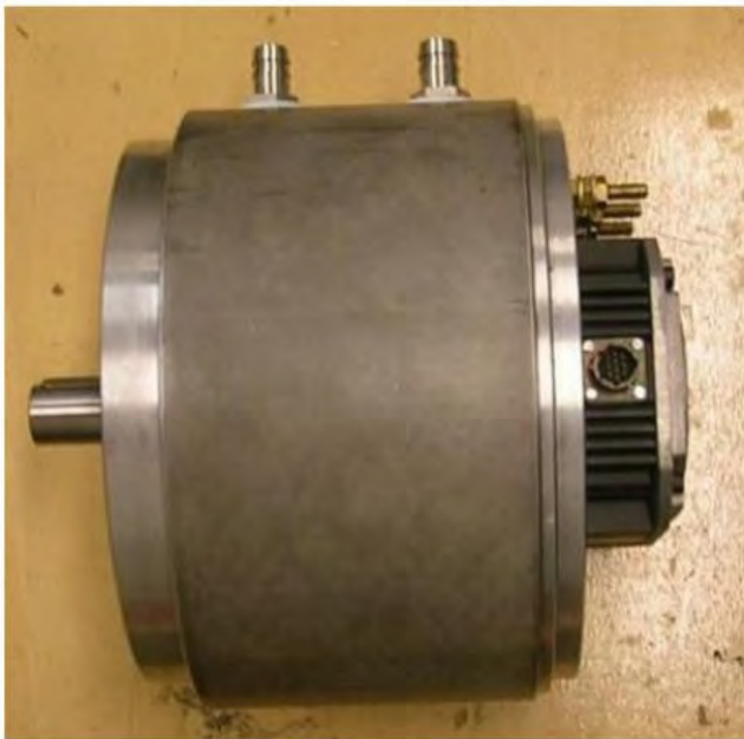
Figura 4 - Motore elettrico del veicolo elettrico Urbe
