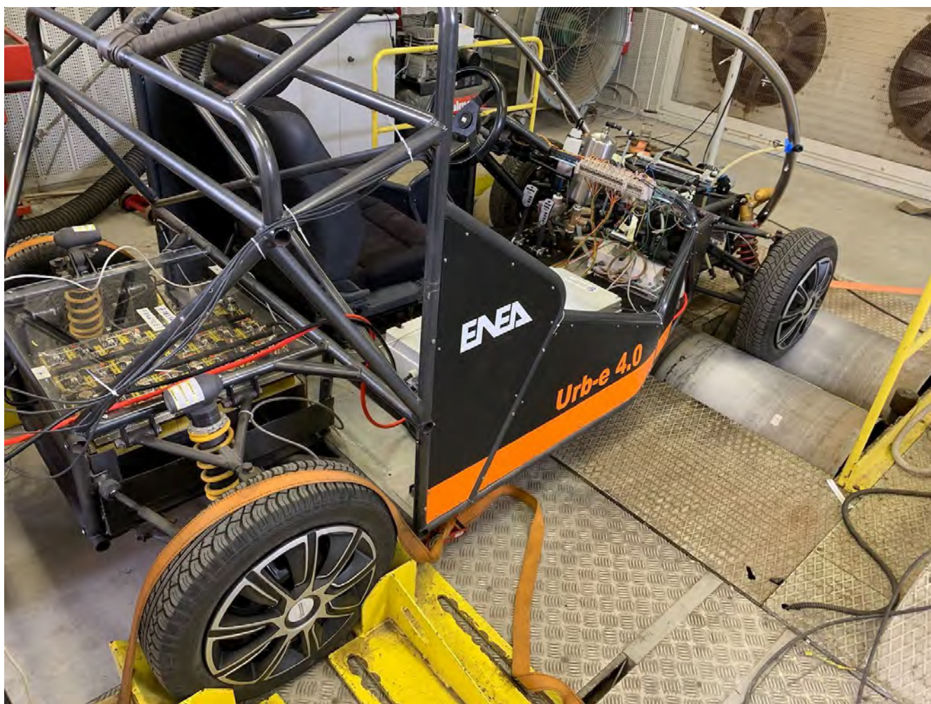
Figura 18 – Il veicolo elettrico URBE posizionato sul banco a rulli dell'ENEA
