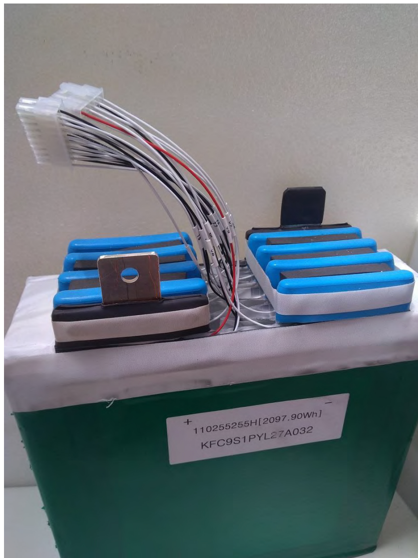
Figura 36: Modulo Kokak composto da 9 celle in parallelo. In evidenza i connettori per il collegamento al ciclatore e i busbar per il controllo dei parametri di cella.
