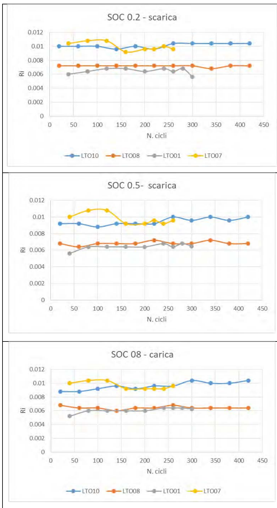
Figura 15: Andamento della resistenza interna in funzione del numero di cicli per celle invecchiate a diverse temperature. I pannelli illustrano i risultati per diversi livelli di stato di carica. Dall'alto verso il basso: SOC= (20, 50, 80). LTO10 e LTO08 T=25°C; LTO1 e LTO7 T=42°C.
