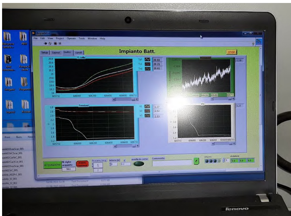
Figura 1 Sistema di acquisizione LabVIEW con monitoraggio in tempo reale dei parametri.
