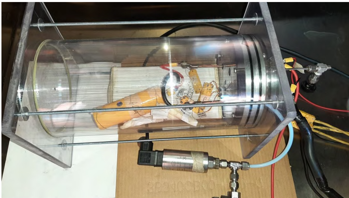
Figura 33 Dettaglio del set-up di prova: cella strumentata da testare in sovrascarica
