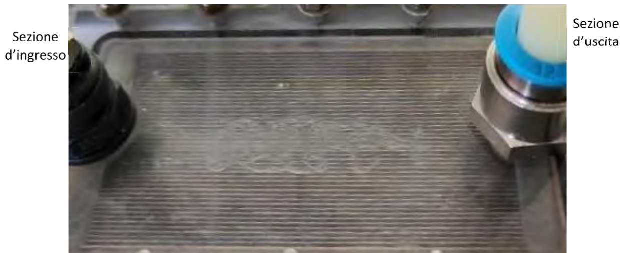
Figura 43. Inizio ebollizione forzata nell'evaporatore
