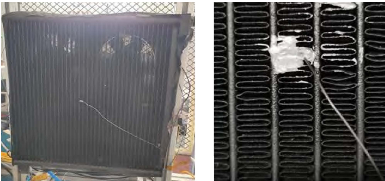
Figura 32. Condensatore rivestito di vernice nera e dettaglio termocoppia
