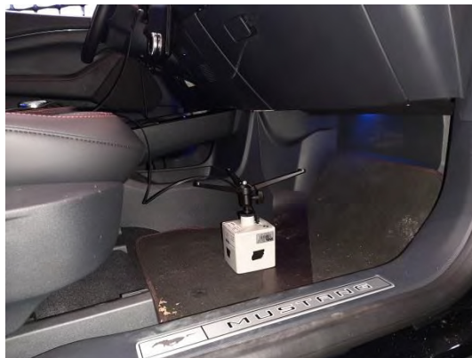
Figura 11: EHP 50G posizionato capovolto sul fondo anteriore dell'auto
