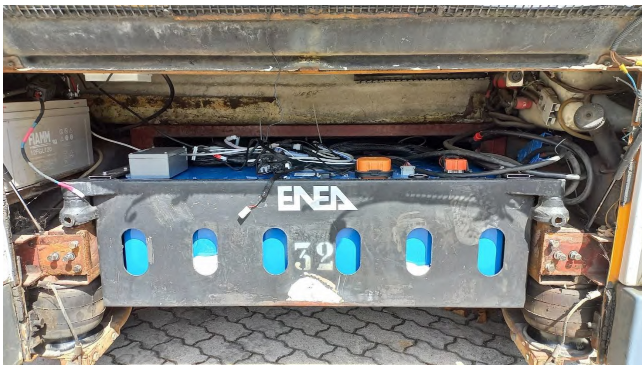
Figura 3: Batteria da 16.3 kWh installata in uno dei due cassoni del Tecnobus Gulliver
