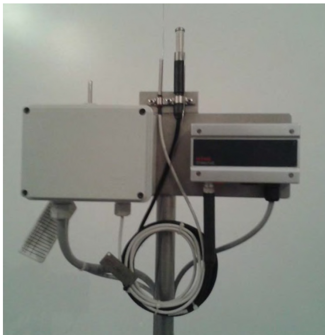
Figura 4: Centralina controllo temperatura e umidità dell'aria asservita all'impianto Calorimetro Enea.
