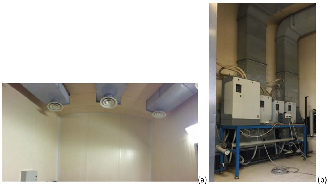
Figura 6. Compensatori (a) ed umidificatori ad elettrodi immersi (b) posti all'interno del calorimetro
