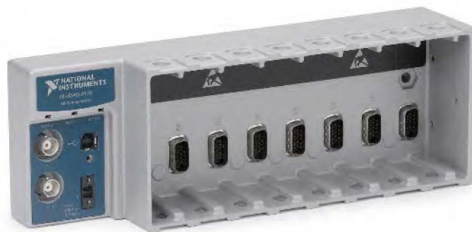
Figura 45. Chassis di alimentazione e collegamento delle schede NI
