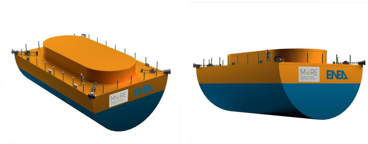
Figura 69 Render del PeWEC. Vista esterna. La linea di galleggiamento è evidenziata dalla separazione dei colori. Sono rappresentati in maniera schematica gli elementi di connessione dell'ormeggio sulla coperta che comprendono i fairlead e chaistopper e fissaggio della catena.
