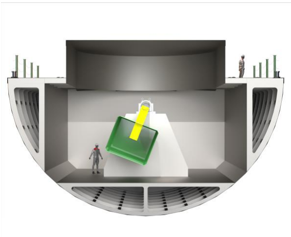
Figura 70 Viste interne del PeWEC. Si evidenziano le nervature di rinforzo dello scafo, I gavoni per l'alloggio della zavorra e l'unità pendolare posta al centro dello scafo.
