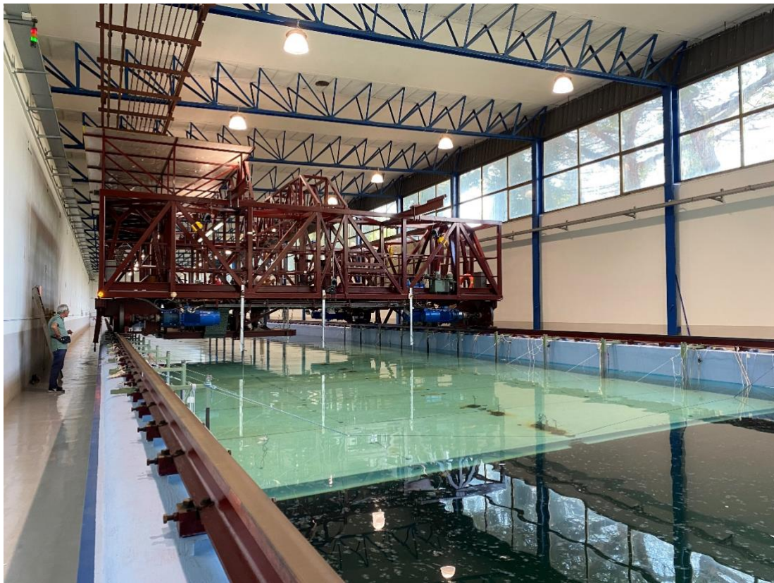
FIGURA 14. SETUP SPERIMENTALE DELLA VASCA CON FONDO ARTIFICIALE, CARRO DINAMOMETRICO, TELECAMERE DEL SISTEMA DI MOTION CAPTURE E WAVE PROBES.
