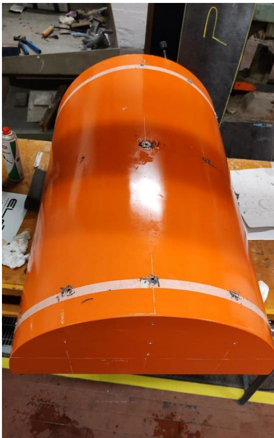
FIGURA 3 INCOLLAGGIO DEI SENSORI DI PRESSIONE SULLO SCAFO.
