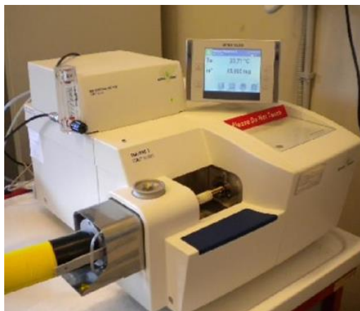
Figura 18. Esempio di una TGA (METTLER TOLEDO TGA1 STAR SYSTEM).
