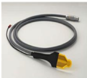
Figura 20. Componenti dello strumento TPS3500 della HotDisk AB (Transient Plate Source)
