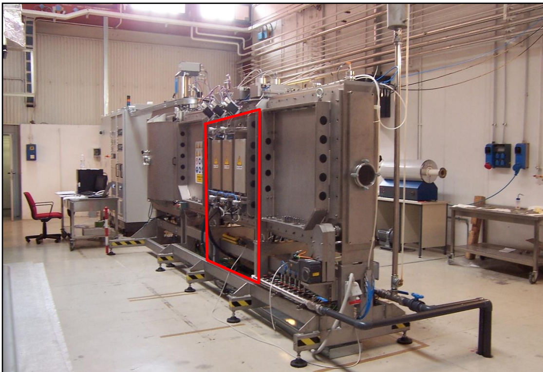
Figura 1. Vista generale dell'impianto di sputtering multi-catodo dell'ENEA con evidenziata la sezione di deposizione
