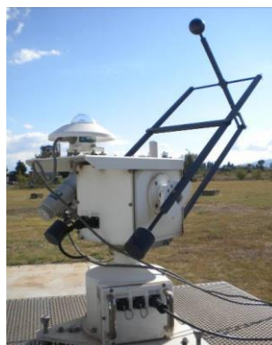
(b) Inseguitore solare per il monitoraggio della DNI
