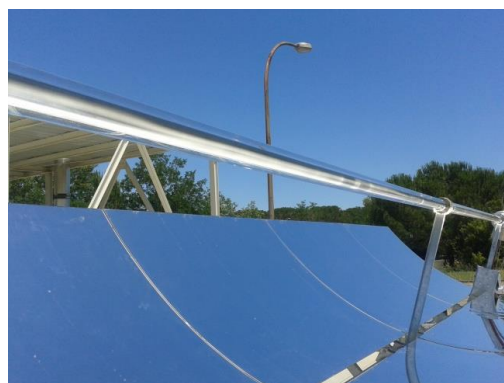
(d) Dettaglio del tubo ricevitore durante i test
