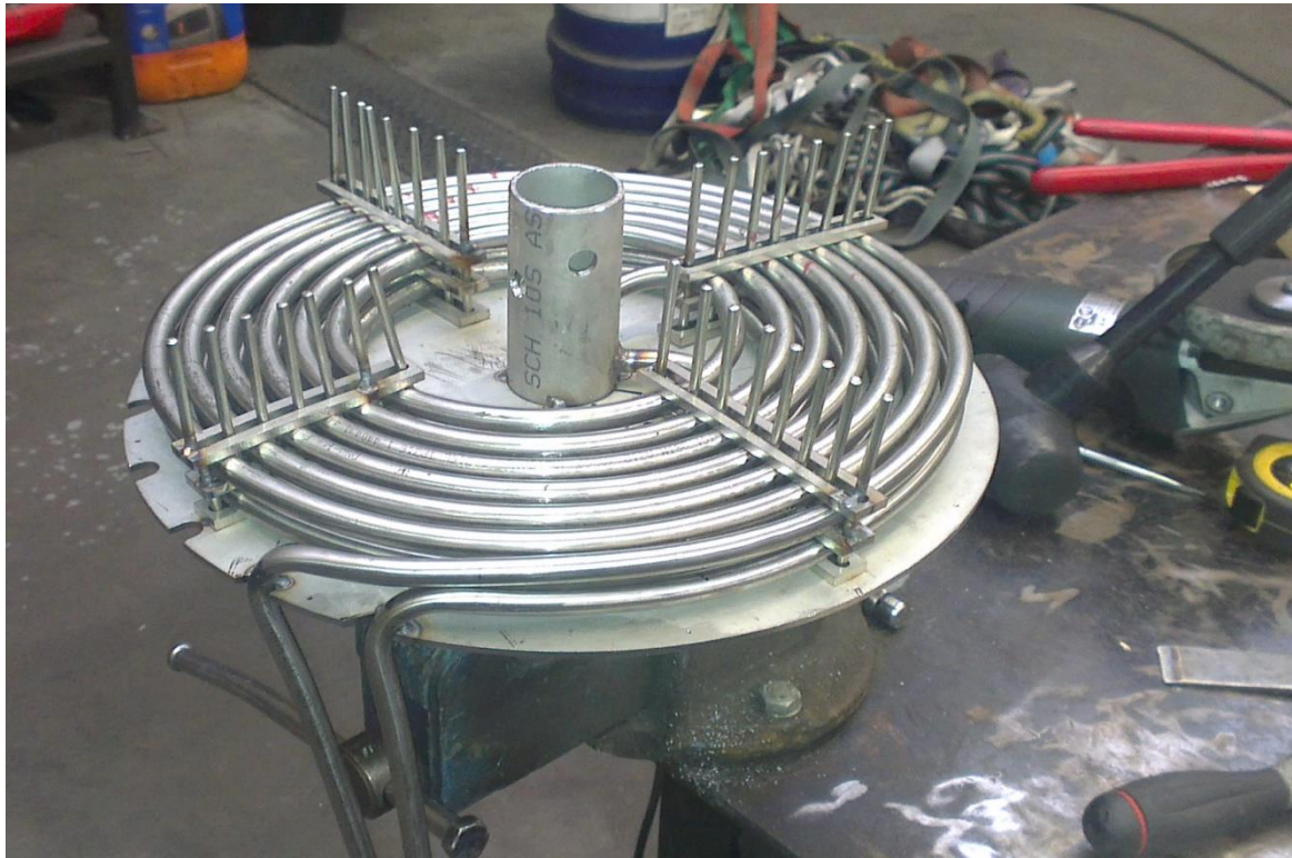
Figura 6. Scambiatore in fase di costruzione
