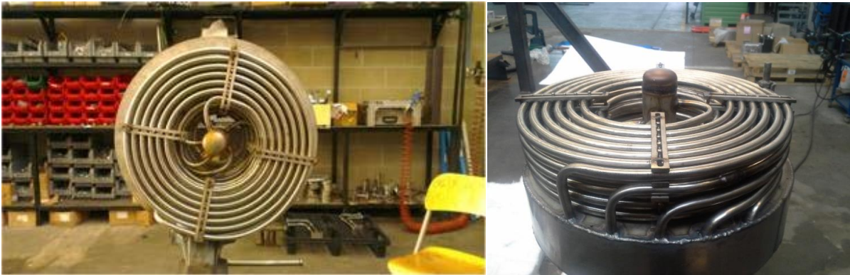
Figura 7. Scambiatori di calore realizzati, prima della loro installazione all'interno del serbatoio.
