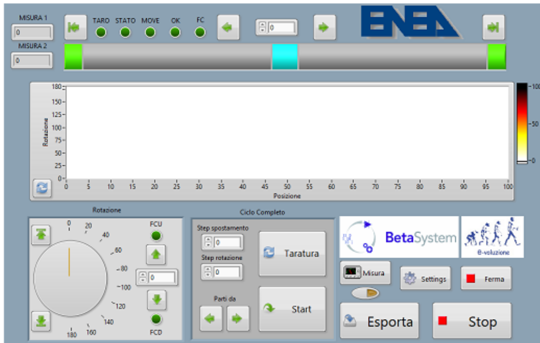
Figura 13: Interfaccia grafica del software di acquisizione e controllo
