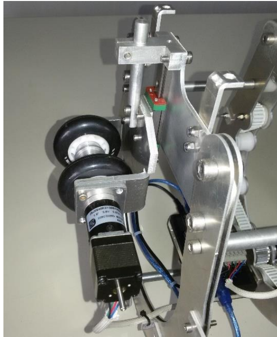
Figura 7b: Dettaglio del sistema di traslazione orizzontale
