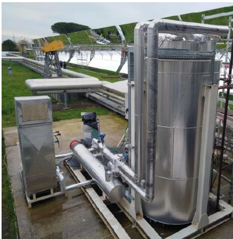
Figura 2. Il prototipo del sistema di accumulo a singolo serbatoio di tipo termoclino installato presso l’impianto PCS nel centro ENEA della Casaccia [3]
