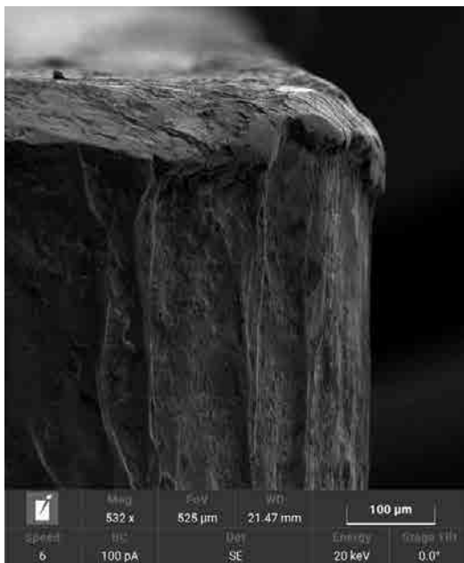
Figura 38 - Analisi SEM del campione B1 effettuata con un ingrandimento di 500x, l'immagine acquisita con gli elettroni secondari (SED) a sinistra e quella con gli elettroni retro diffusi (BSD) a destra
