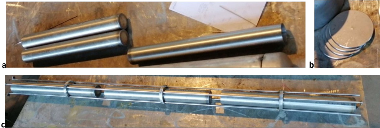
Figura 26- Capsule per NEPCM: a) Corpo di 3 capsule con fondo saldato; b) tappi di chiusura capsule da saldare dopo introduzione del NEPCM; c) capsule inserite all'interno del cestello porta-capsule.
