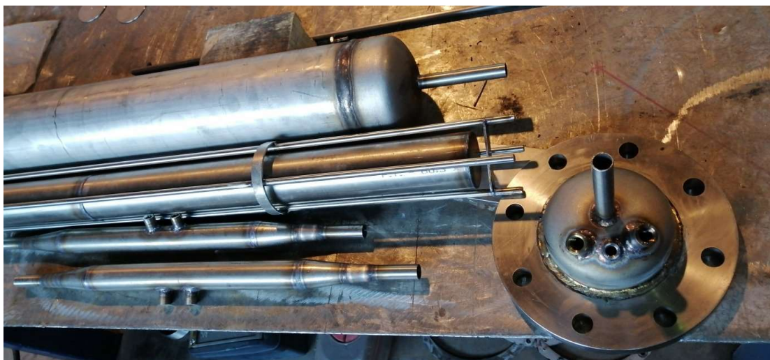
Figura 30- Insieme dei principali componenti realizzati per il prototipo LHTES ENEA-TES-LHC01
