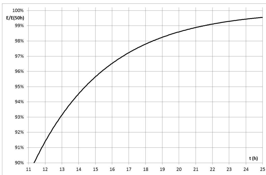
Figura 18- Evoluzione temporale E/E(50\text{ h}) nella coibentazione, particolare
