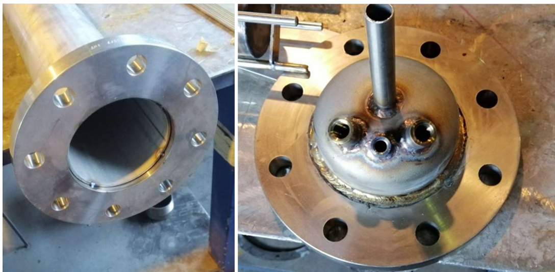
Figura 28- Flangia del corpo cilindrico del contenitore (sinistra) e coperchio flangiato con fori di uscita termocoppie e sfiati (destra).
