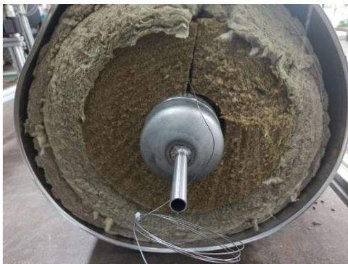
Figura 32- Prototipo ENEA-TES-LHC01 parzialmente coibentato e pronto per la fase di installazione: a) completo; b) lato fondo; c) lato coperchio.
