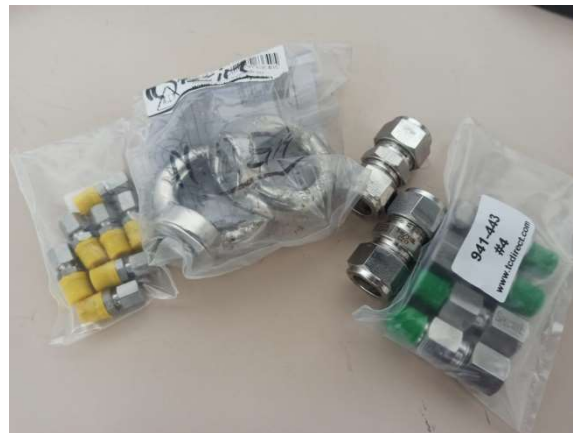
Figura 31- Alcuni accessori per la connessione e il montaggio del prototipo, compresi connettori di piping a pressione, golfari e passanti di tenuta per sensori singoli e multipli.
