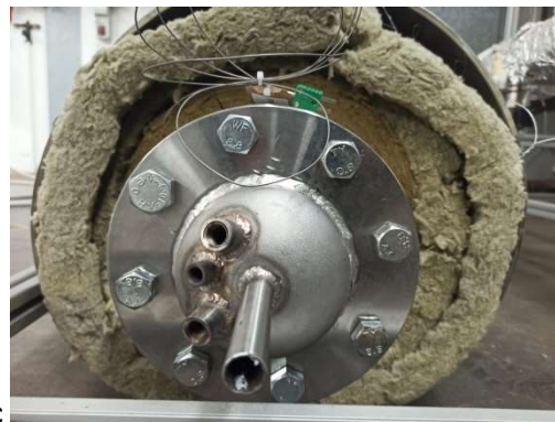
Figura 32- Prototipo ENEA-TES-LHC01 parzialmente coibentato e pronto per la fase di installazione: a) completo; b) lato fondo; c) lato coperchio.
