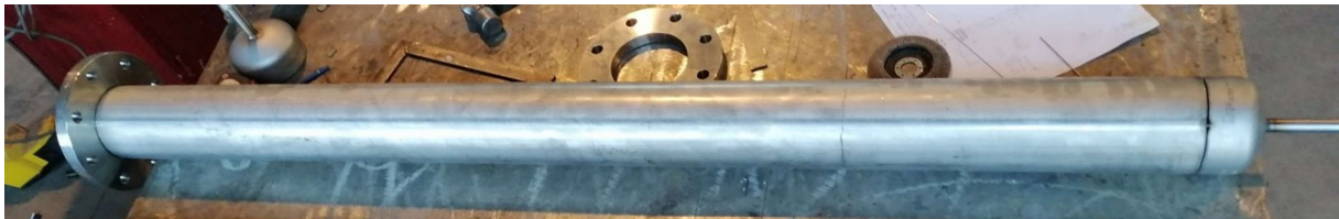
Figura 27- Contenitore cilindrico per capsule con fondo saldato da un lato (destra) e flangia dal lato opposto (sinistra).
