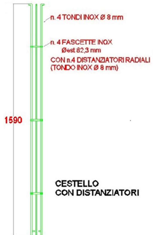
Figura 23- Disegno del cestello porta-capsule del prototipo ENEA-TES-LHC01
