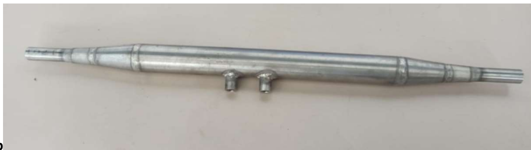
Figura 29- Sezioni di misura temperatura HTF (due) esterne al prototipo: a) singoli pezzi costituenti le due sezioni; b) sezione di misura assemblata con fori per l'introduzione di una termocoppia e di una termoresistenza.
