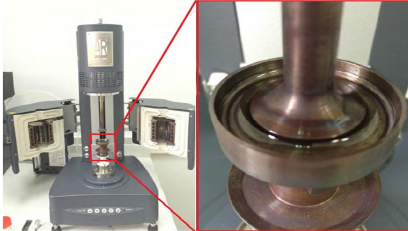
Figura 6 - Reometro AR 2000ex utilizzato e posizionamento del campione per le misure di viscosità.
