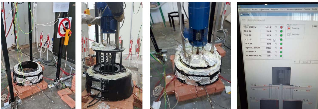
Figura 5– Set-up sperimentale per le prove di corrosione in dinamico: da sinistra, contenitore in acciaio con il sale fuso pronto per la prova, l'immersione dei provini di acciaio fissati ad una griglia di supporto, il sistema chiuso e coibentato e un particolare del software di controllo strumentazione.
