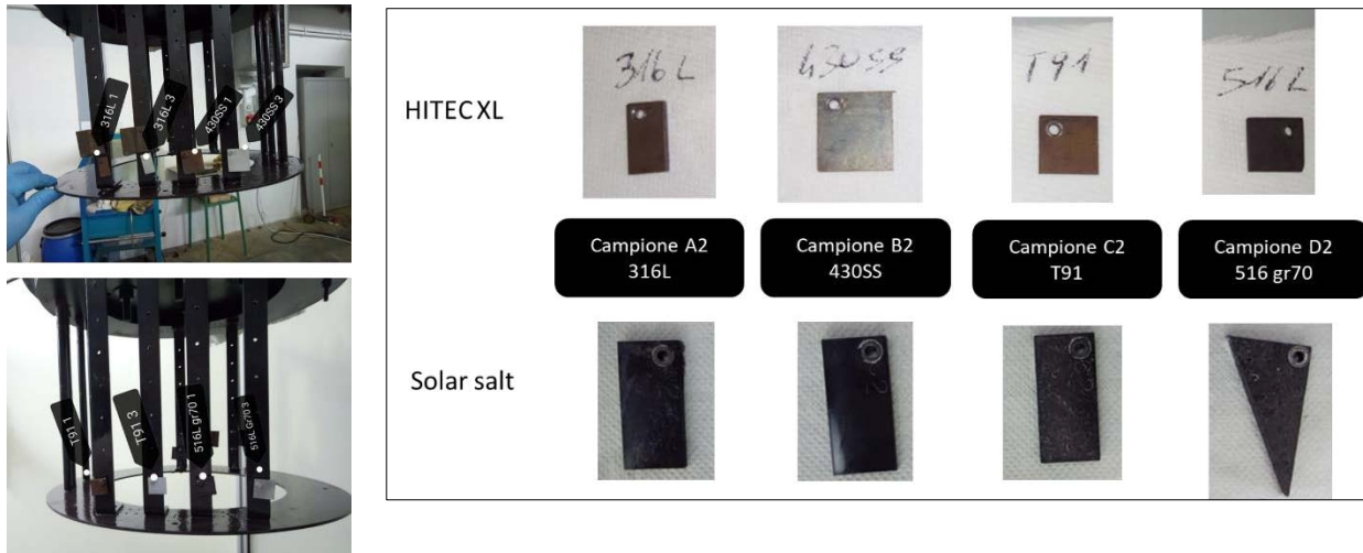
Figura 6 - Un particolare della fase di estrazione a tempi diversi (a sinistra) e i provini estratti puliti (dopo 1000 h), pronti per essere trattati (a destra).
