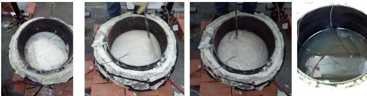
Figura 4 – Set-up sperimentale per le prove di corrosione in dinamico: contenitore in acciaio in cui è stato caricato e fuso il sale per entrambi i test.
