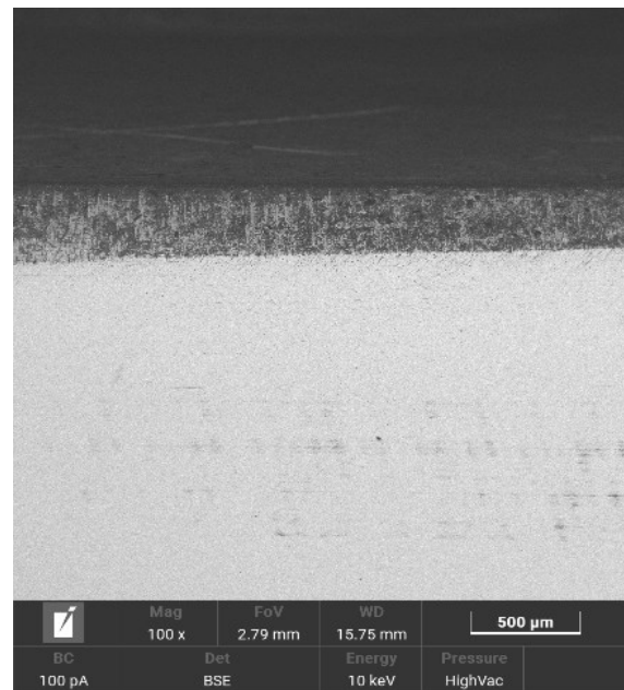
Figura 42 - Analisi SEM del campione C3 - T91 effettuata con un ingrandimento di 100x, l'immagine acquisita con gli elettroni secondari (SE) a sinistra e quella con gli elettroni retro diffusi (BSE) a destra
