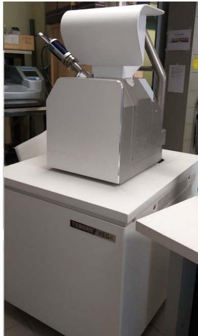
Figura 4 – Immagine del microscopio elettronico utilizzato per l'analisi dei provini di acciaio
