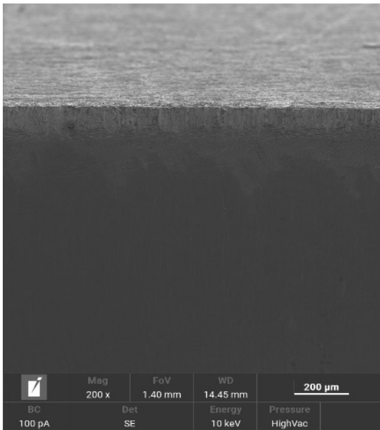
Figura 33 - Analisi SEM del campione A3 - 316L effettuata con un ingrandimento di 200x, l'immagine acquisita con gli elettroni secondari (SE) a sinistra e quella con gli elettroni retro diffusi (BSE) a destra
