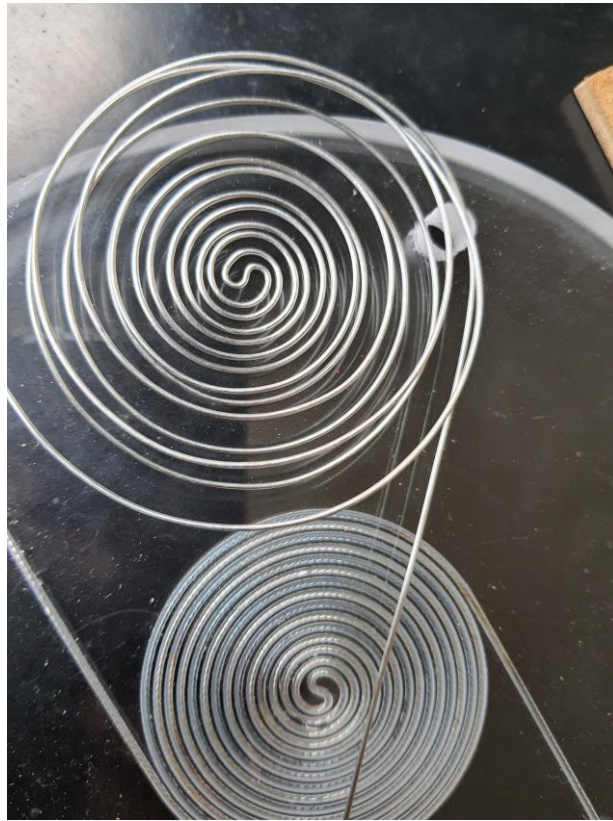
Figure 16 Filo scaldante a treccia incastonato all'interno dell'alloggiamento nel quarzo, all'esterno il cavo scaldante da 1 mm.
