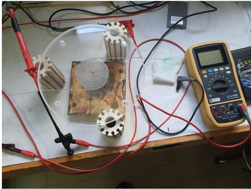
Figure 5 Test per la misura della resistenza elettrica del cavo a treccia Ni/Cr.
