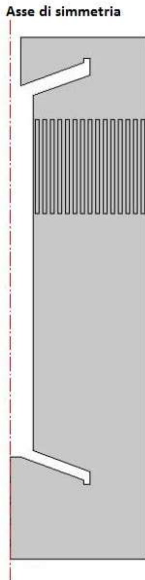
Figura 10- Geometria modello CFD sistema di accumulo termico a termoclino con NEPCM
