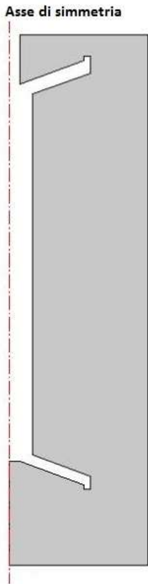
Figura 4- Geometria modello CFD sistema di accumulo termico a termoclino
