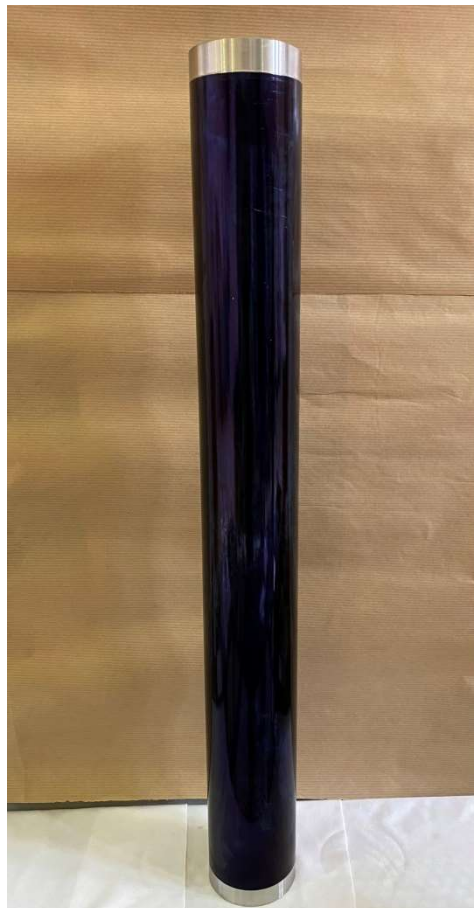
Figura 2. Immagine del prototipo di coating realizzato per operare in vuoto alla temperatura di 550^\circ\text{C} , depositato su tubo di acciaio
