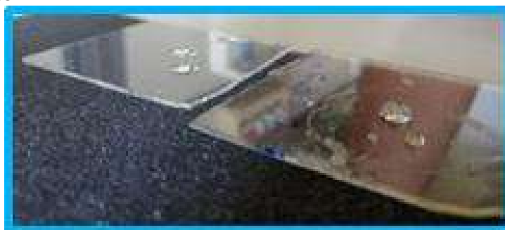
Figura 20: Confronto qualitativo della bagnabilità di vetro e film di POSS 15 (a destra).
