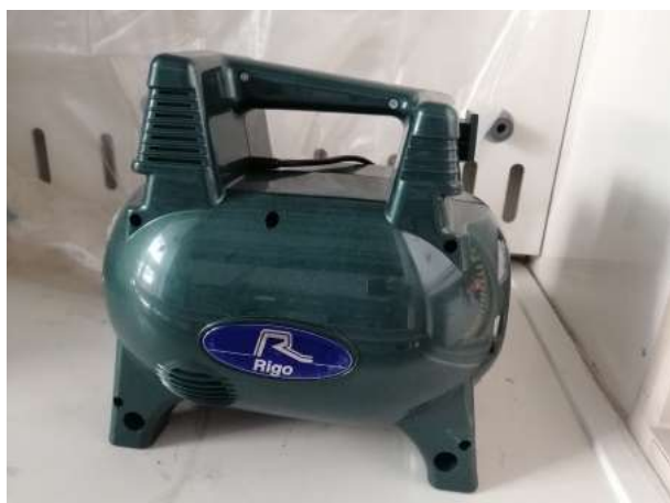
Figura 24: Turbina per la polverizzazione/nebulizzazione dei prodotti in un getto d'aria
