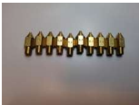
Figura 25: Set di ugelli intercambiabili in funzione della densità/viscosità del prodotto da applicare.
