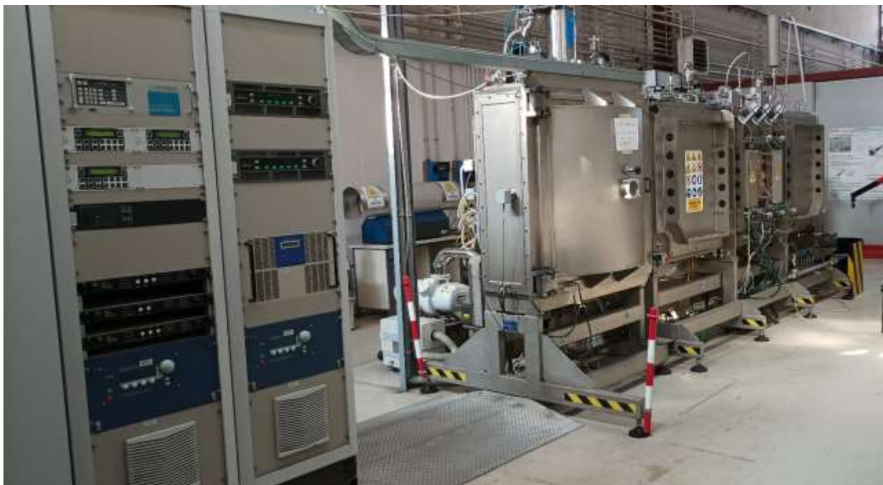
Figura 3: Foto impianto di sputtering in dotazione al laboratorio SCIS
