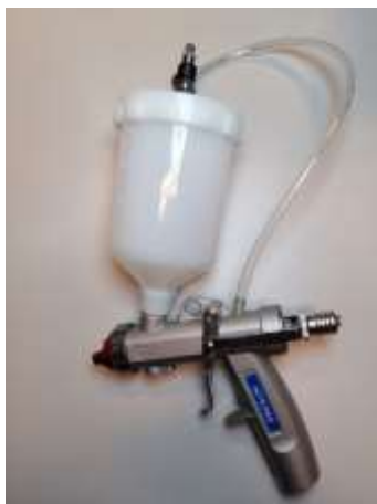
Figura 22: Pistola a spruzzo/aerografo HVLP
