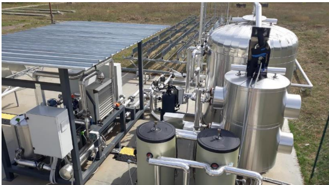
Figura 10 – Foto del circuito E/C che connette il phase-changer al reattore in sperimentazione
