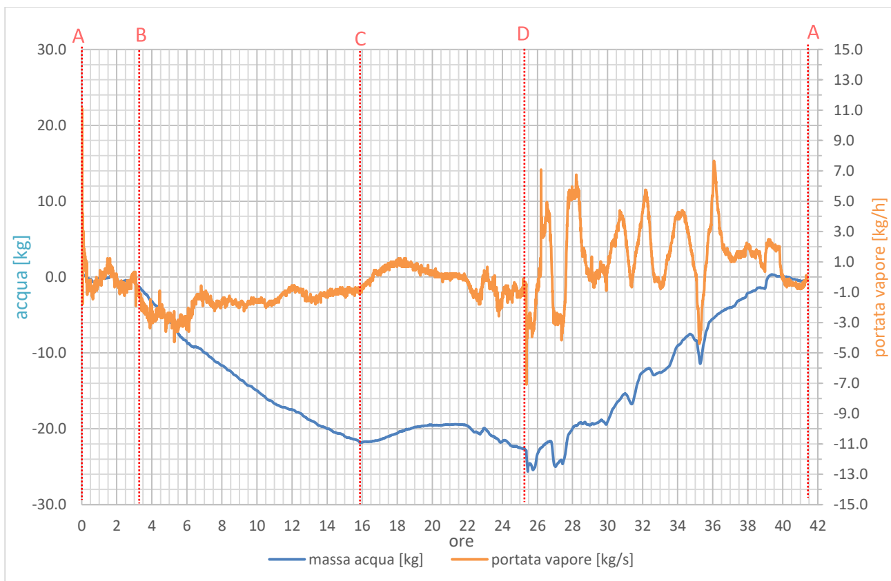
Figura 27 - Portata di vapore e massa d'acqua scambiata nel phase-changer - Ciclo 3
