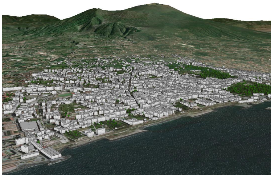
Figura 15. Modello 3D (LOD2) dell'edificato e dalla vegetazione della città di Portici
