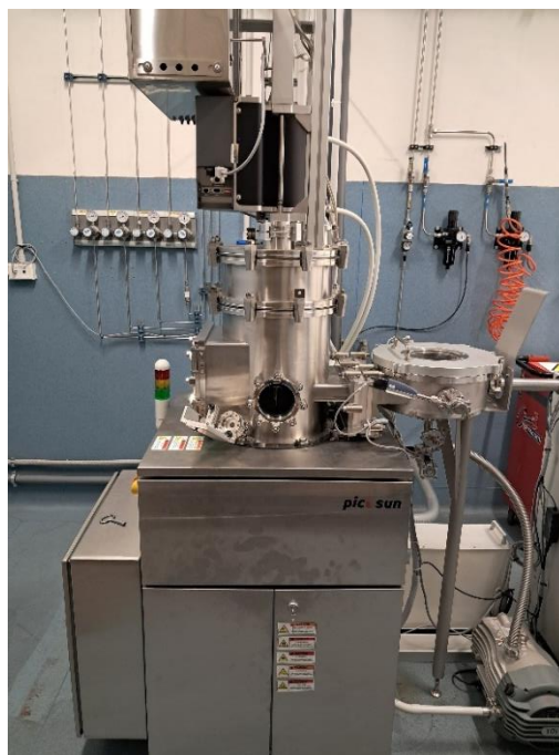
Figura 1: Foto del reattore ALD utilizzato per le deposizioni del \text{TiO}_2 e del \text{WO}_x .
